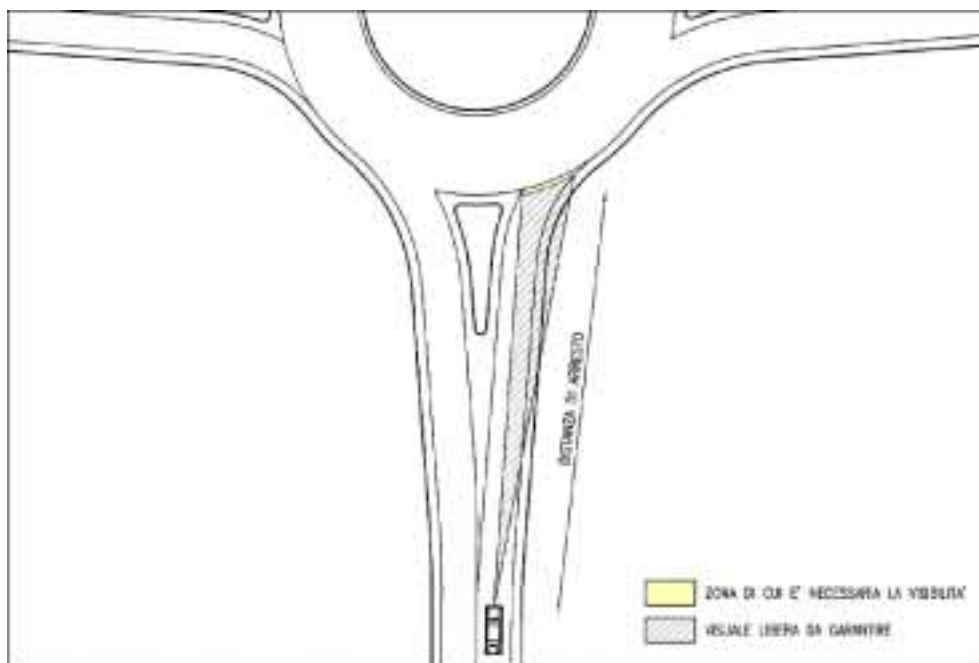
Figura 5-11 – Distanza di visibilità per l'arresto da garantire nel ramo di ingresso in rotonda.
